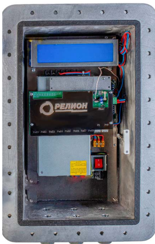
Рисунок 4. Вид изнутри (для примера представлен коммутатор с индексом UPS)
