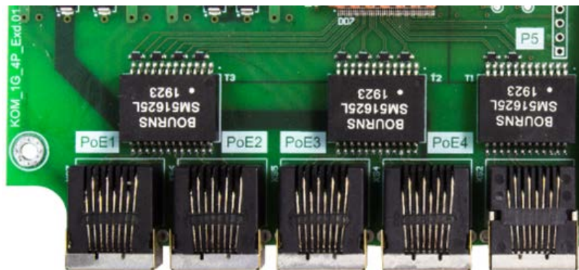
Рисунок 6. Порты Ethernet коммутатора
